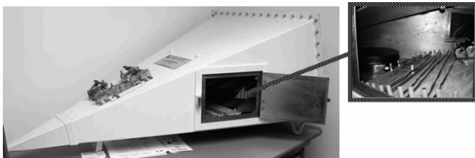
Figure 5. GTEM (ETS-Lindgren IC-GTEM 250).
